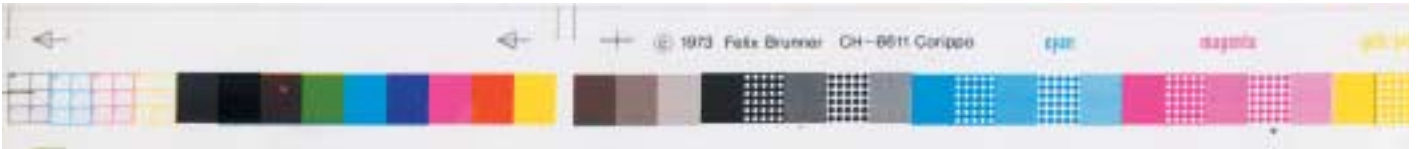
Der Druckkontrollstreifen System Brunner 2. Gen. (1973) zur Prüfung von Punktverbreiterung, Farbbalance, Volltondichte, Trapping, Spitzpunkten.
